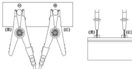
8. 直接於 LCD 顯示上讀取電池內部電阻值、直流電壓及溫度，欲改變溫度顯示單位為 “°F” 請按下
